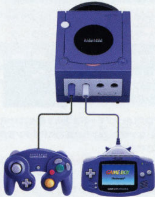
【ゲームボーイアドバンス・ニンテンドーゲームキューブとGBAケーブルの接続図】
